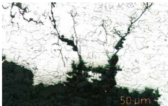
Exemple de fissure de contrainte transcristalline liée à la corrosion sur de l'acier inoxydable 1.4401 avec une concentration en chlorure élevée.
