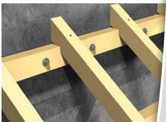
Fixation d'une muraille sur béton
