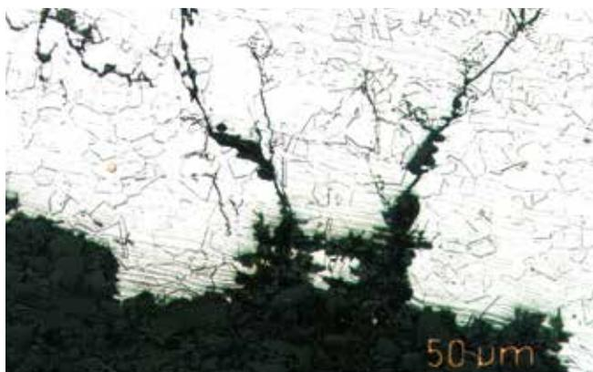
Exemple de fissure de contrainte transcritalline liée à la corrosion sur de l'acier inoxydable 1.4401 avec une concentration en chlorure élevée.
