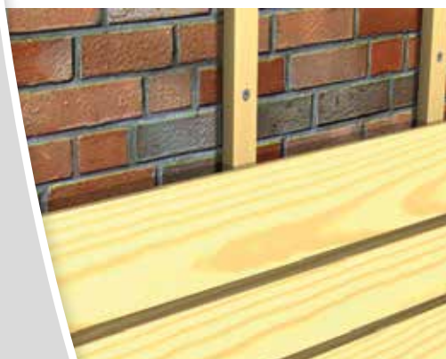
Fixation de tasseaux sur maçonnerie pleine
