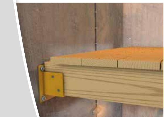
Fixation de connecteurs métalliques sur mur béton
