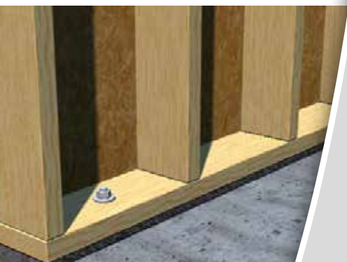
Fixation de lisses basses sur béton
