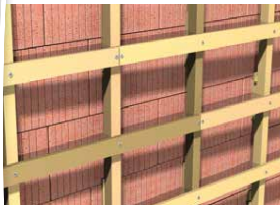
Fixation de tasseaux sur support creux
