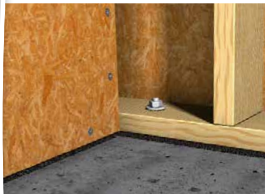
Fixation chimique lisse basse
