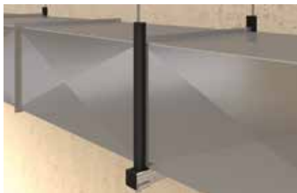
Gaine de ventilation avec isolation phonique sur rail
