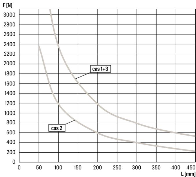
Dans les courbes de charge, la contrainte admissible de l'acier  $\delta_{adm} = 188 \text{ N/mm}^2$  (déformation accrue de l'acier due à la flexion) et la flèche maximale  $L/150$  ne sont pas dépassées. Les chevilles et vis de fixation doivent reprendre les charges correspondantes.
