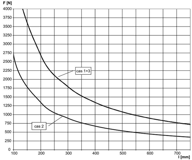
Dans les courbes de charge, la contrainte admissible de l'acier  $\delta_{adm.} = 160 \text{ N/mm}^2$  (déformation accrue de l'acier due à la flexion) et la flèche maximale  $L/150$  ne sont pas dépassées. Les chevilles et vis de fixation doivent reprendre les charges correspondantes.
