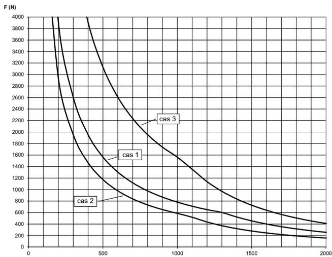
Dans les courbes de charges, la contrainte admissible  $\sigma_{adm} = 188 \text{ N/mm}^2$  ainsi que la flèche  $L/200$  ne sont pas dépassées. Les chevilles et vis de fixation doivent reprendre les charges correspondantes. L'augmentation de la limite d'élasticité est calculée selon DIN EN 1993-1-3:2010-12, § 3.2.2.
