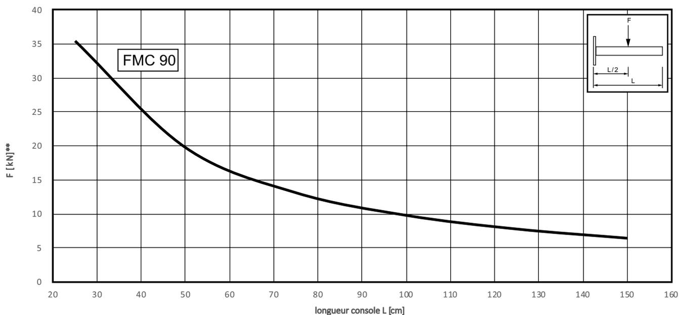
\*\* La contrainte admissible est calculée selon EN 1993;  $\delta_{rec} = f_{yk} / (\gamma_L \cdot \gamma_{M0})$  avec  $\gamma_L = 1,4$  et  $\gamma_{M0} = 1,0$ . Est déterminante la valeur minimale de contrainte admissible (cisaillement, flexion, combinée) ou la flèche maximale (L/150).
