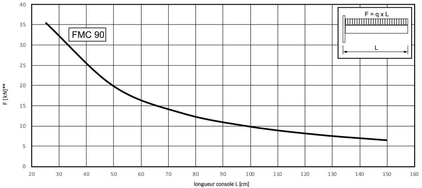
\*\* La contrainte admissible est calculée selon EN 1993;  $\delta_{rec} = f_{yk} / (\gamma_L \cdot \gamma_{M0})$  avec  $\gamma_L = 1,4$  et  $\gamma_{M0} = 1,0$ . Est déterminante la valeur minimale de contrainte admissible (cisaillement, flexion, combinée) ou la flèche maximale (L/150).
