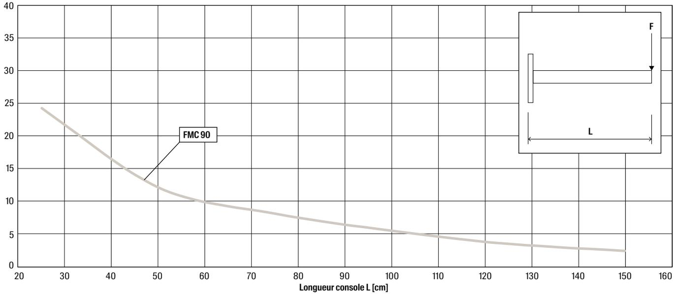
\*\* La contrainte admissible est calculée selon EN 1993;  $\delta_{rec} = f_{yk} / (\gamma_L \cdot \gamma_{M0})$  avec  $\gamma_L = 1,4$  et  $\gamma_{M0} = 1,0$ . Est déterminante la valeur minimale de contrainte admissible (cisaillement, flexion, combinée) ou la flèche maximale (L/150).
