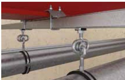
Fixation de rails sur poutrelles métalliques
