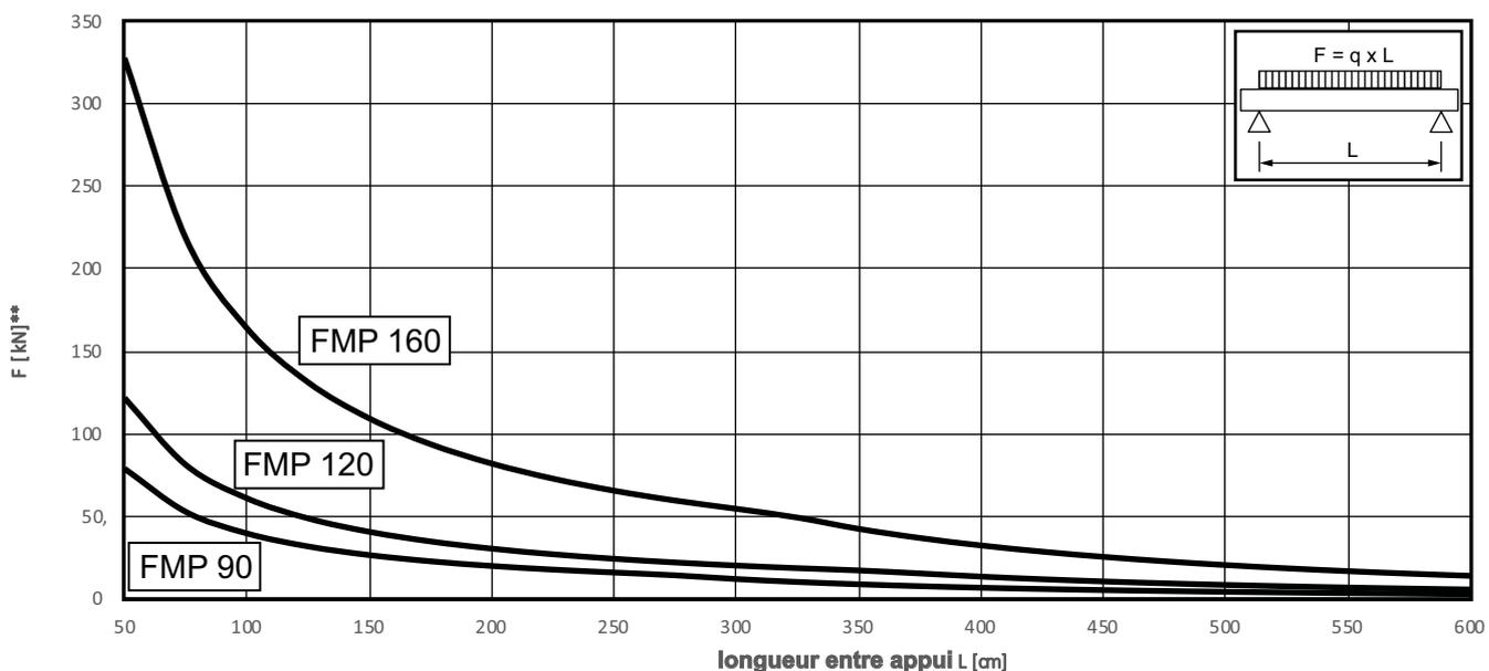
\*\* La contrainte admissible est calculée selon EN 1993;  $\delta_{rec} = f_{yk} / (\gamma_L \cdot \gamma_{M0})$  avec  $\gamma_L = 1,4$  et  $\gamma_{M0} = 1,0$ . Est déterminante la valeur minimale de contrainte admissible (cisaillement, flexion, combinée) ou la flèche maximale (L/200).
