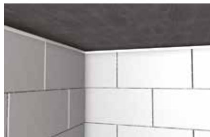
Joint de construction entre voile et dalle
