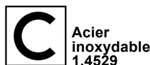
Le produit est disponible en **acier hautement résistant à la corrosion** de la classe V de résistance à la corrosion (par exemple 1.4529).
