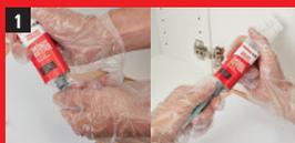
Mettre des gants et ouvrir le capuchon . Visser l'embout mélangeur.
