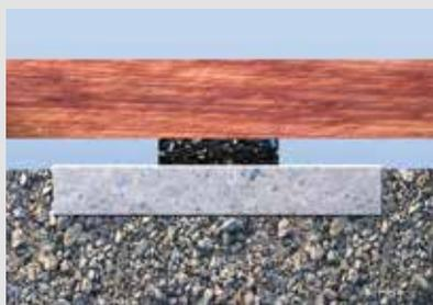
La cale de réhausse FTA-UP doit être placée entre le sol et la lambourde pour assurer l'écoulement de l'eau et éviter une stagnation qui dégradera le bois à moyen terme.
