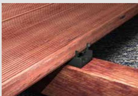
Le clip FTA-IPW assure une installation rapide, invisible et durable des lames de terrasse bois sur lambourdes bois. Réglable de 120 à 150 mm. Écartement des lames automatique de 5 mm grâce à ses ergots espaceurs.
