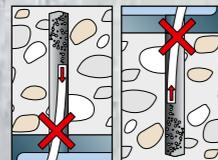
*Pour le trou au sol : augmentation de la profondeur de perçage de 3x le Ø du foret.*
