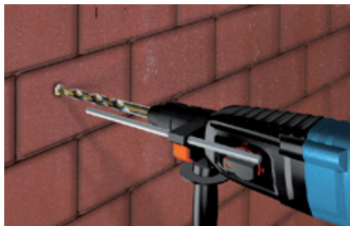
Perçage dans la brique
