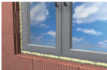
Joint d'étanchéité de fenêtres
